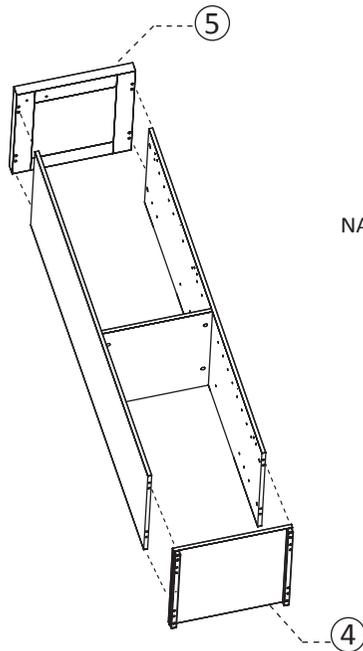
NA SEQUENCIA FIXAR A BASE (4) COM O RODAPÉ PRÉ-MONTADO, TAMPO ENGROSSADO (5)
