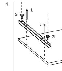
ROSQUEAR NIVELADORES NO RODAPÉ METALICO E POSICIONAR PARAFUSOS ESTRUTURAIS NA BASE
