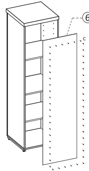
POSICIONE O FUNDO DE 3mm (6) NO ARMARIO E PREGUE COM O AUXÍLIO DE UM MARTELO
